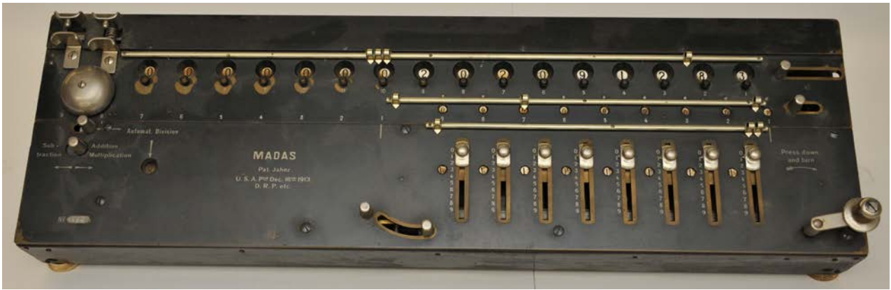
Abbildung 2: Madas. Die leistungsfähige mechanische Vierspeziesrechenmaschine war weit verbreitet (© Credit Suisse, Zürich).
